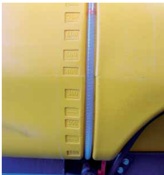
Jauge équipant une cuve de pulvérisateur
