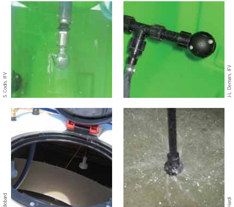
Buses de rinçage permettant de laver les parois internes de la cuve du pulvérisateur
