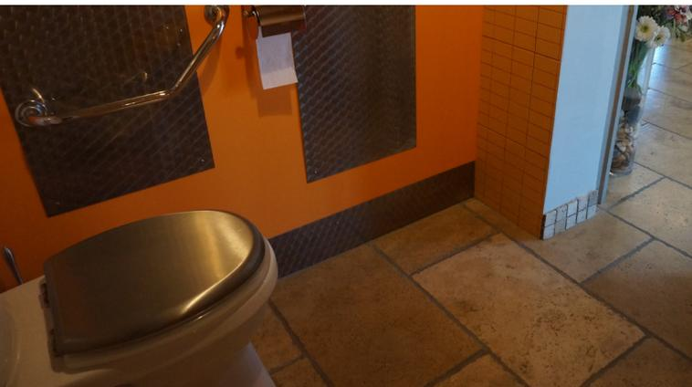
Les sanitaires aménagés aux personnes en fauteuil roulant doivent disposer d'un espace plus grand pour pouvoir manœuvrer. Vous devez implanter un espace de manœuvre avec possibilité de demi-tour à l'intérieur de la cabine. Cette giration ne doit pas être inférieure à 150 cm.
