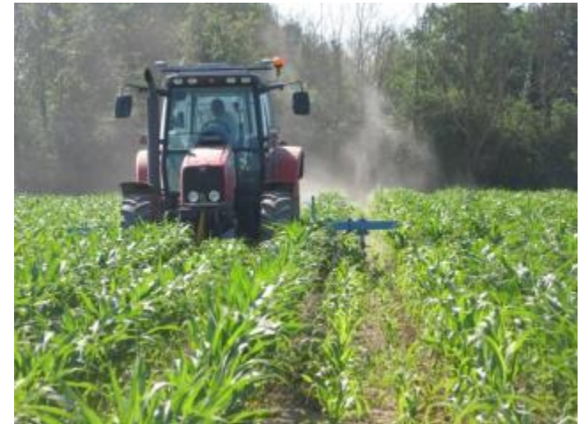
Binage mécanique sur maïs semence avec un autoguidage RTK (2011)
