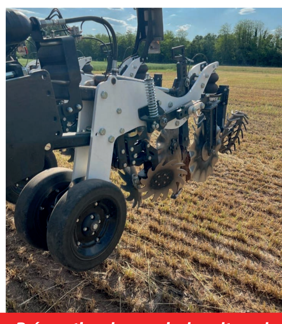
Préparation des semis de culture de printemps maïs grain au striptill dans le chaume du seigle
